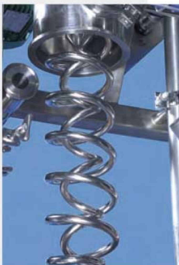
Il profilo della vite preserva la struttura del prodotto.
