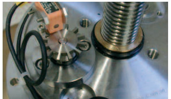
Dosaggio di precisione: la pompa a pistone Dosys™ con sensori di posizionamento ha una precisione pari a +/-0,5%.
