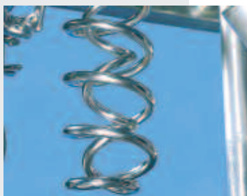
Il profilo a vite protegge la consistenza del prodotto e il tasso di flusso.
