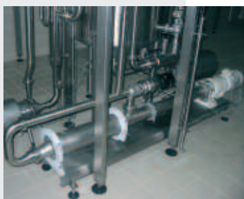
Pompa igienica PCM Moineau™ a cavità progressiva per il trasferimento dello yogurt.
