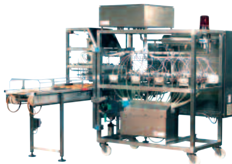
Sistema di riempimento PCM con serie d'iniezione a 32 aghi; produce fino a 21.000 merendine per ora.
