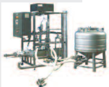
Sistema Doseyfruit con sostituzione automatica del serbatoio vuoto e segnale di avviso.
