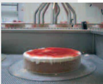
Dosaggio preciso di una delicata salsa di lamponi utilizzata per la glassatura dei prodotti di pasticceria.
